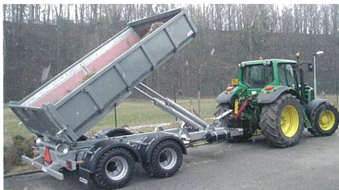
Odvoz sypkých a stavebních materiálů, možnost přistavení různých kontejnerů (univerzální nosič kontejnerů)
